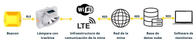
Figura 9. Esquema de seguimiento de personal con lámpara inteligente.
