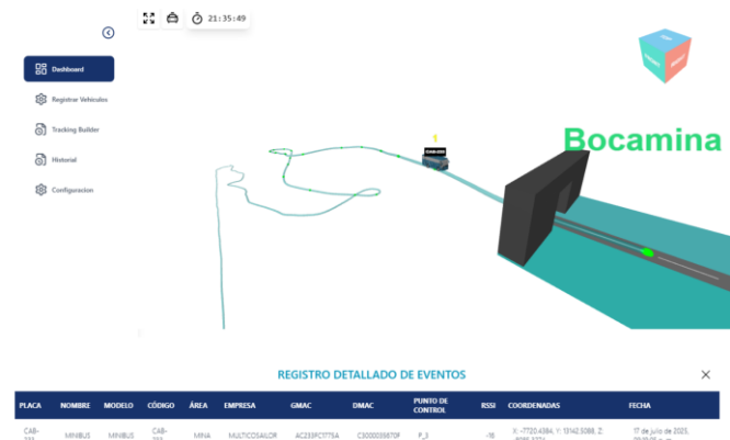
Figura 12. Interfaz de visualización de rutas en el software de monitoreo. Fuente: Elaboración propia (2025).
